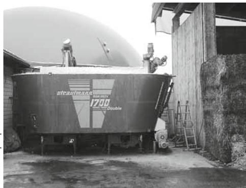
Das angelieferte Material wird in den roten Behälter eingeführt und unter der grünen Haube vergärt.
