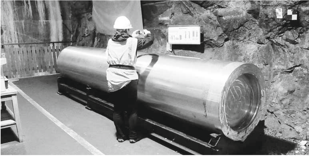
Ein Endlagerbehälter aus massivem Kupfer im Schwedischen Versuchsbergwerk bei Oskarshamn.
